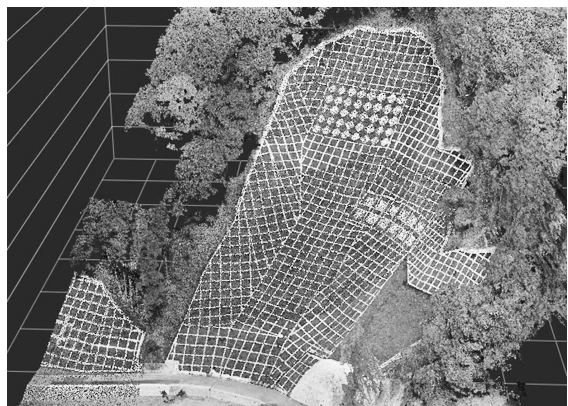
▶ 法面の3次元出来形計測データ
